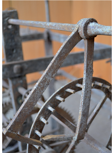
Abb. 3: Stiftskirchenuhr: Ankerhemmung mit Stiftenrad, 19. Jahrhundert (Foto: RMK)
