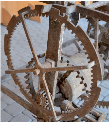
Abb. 4: Stiftskirchenuhr: Schlosseibe des Stundenschlags (Foto: RMK)
