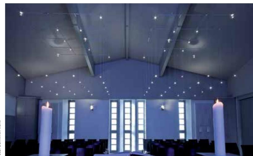
Sternenhimmel: Eine neue Beleuchtung hat das Dietrich-Bonhoeffer-Zentrum in Mellungen erhalten. Das Konzept erarbeitete der Lichtplaner Wolfgang Engelhardt; es besteht aus LED-Wandstrahlern und einer besonderen Deckenbeleuchtung: Das von „benwirth licht“ aus München entwickelte Lichtsystem „\*track“ besteht aus 60 kleinen mit LED bestückten Kugeln, die an einer innovativen Stromverteilung hängen.
